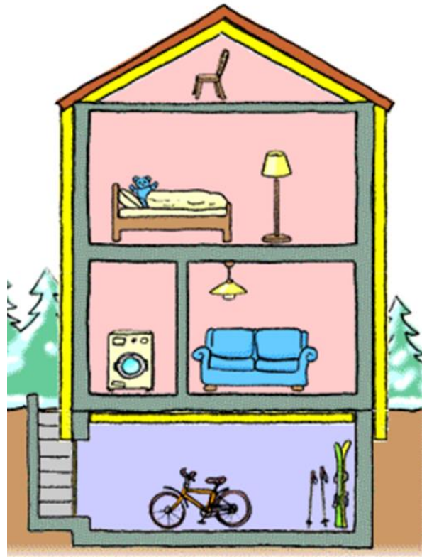
Dämmen Aussenwände aussen
