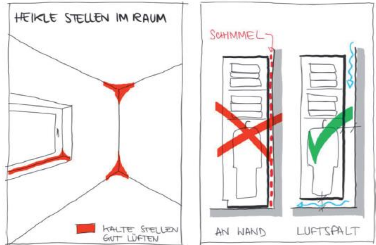
Risikozonen für Schimmelpilzbildung
