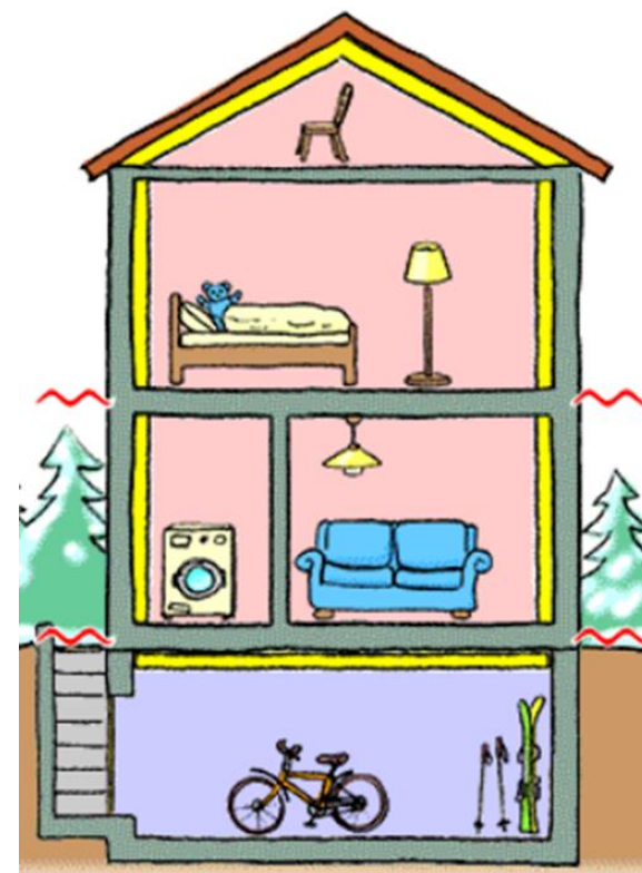
Dämmen Aussenwände innen
